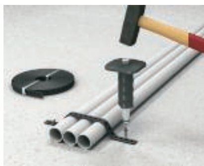
Применение дюбеля ОВО 903/RB с монтажной лентой Дюбель ОВО без резьбы (как 903/RB) подходит для крепления монтажных лент, например, на бетон.
